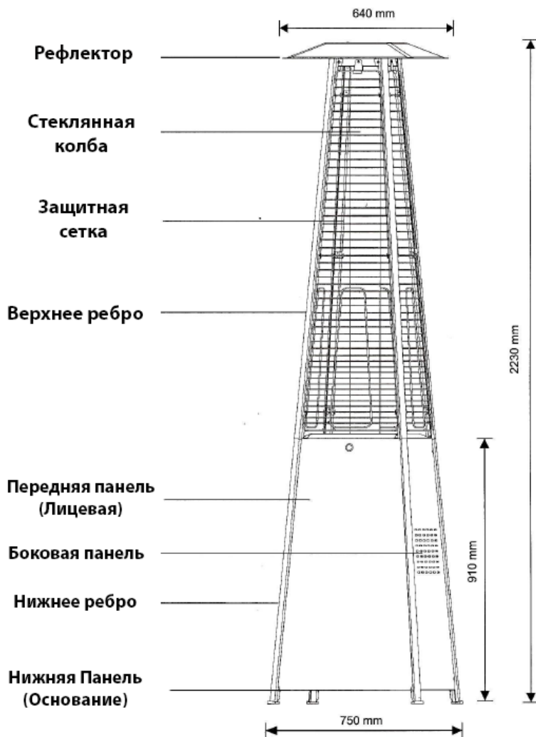
Рис. 1 Конструкция обогревателя «Мастер Лето»
